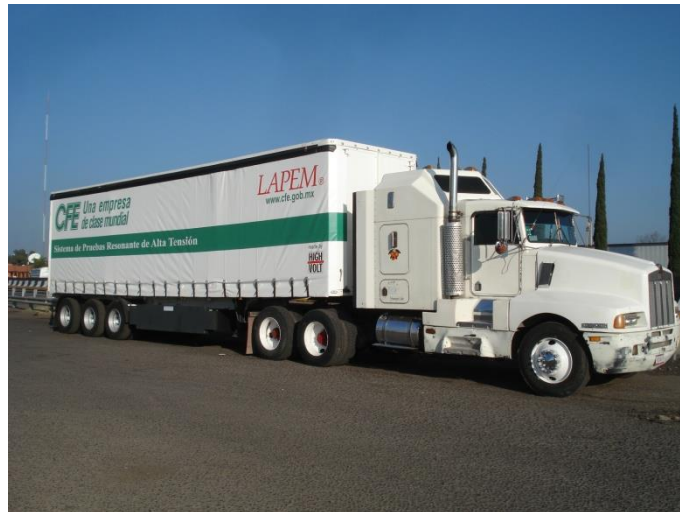
Figura 31.- Sistema de pruebas móvil resonante con medición de DP's a cables subterráneos.
