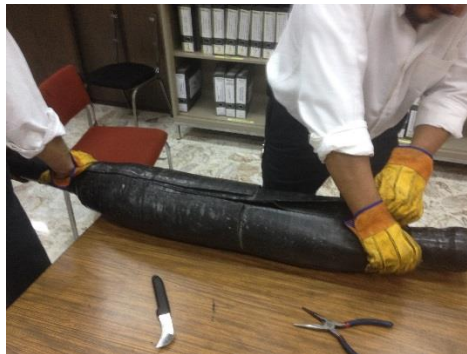
Figura 63.- Disección de un empalme de 115 kV con presencia de descarga superficial
