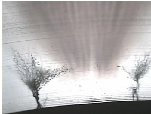
Figura 15.- Arborescencia eléctrica en material aislante consecuencia de descargas parciales internas.
