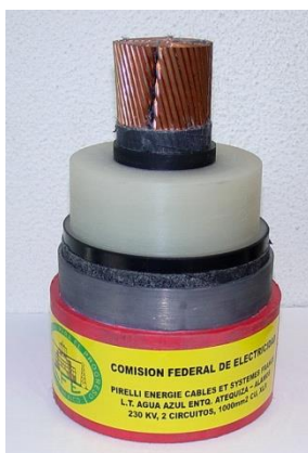
Figura 6.- Cable de Potencia
