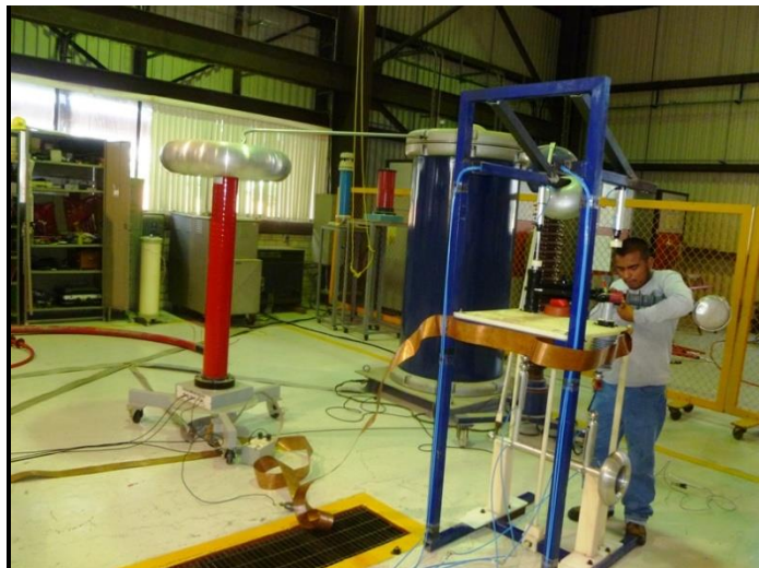
Figura 29.- Plataforma experimental para medición de DP en sistemas subterráneos.
