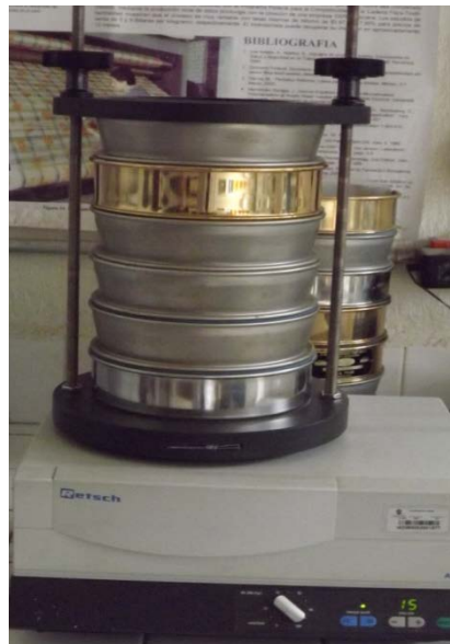
Figura 3.2. Conjunto de tamices utilizados para obtener la distribución de tamaño de partícula.
