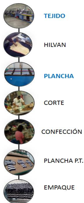
Figura 15. Proceso textil de tejido de punto.
