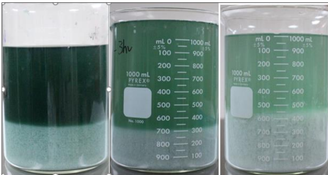
Imagen 13. Comparación de baños residuales de la prueba piloto con recirculación de baños. (De izquierda a derecha: 1er baño, 2do baño, 3er baño.
