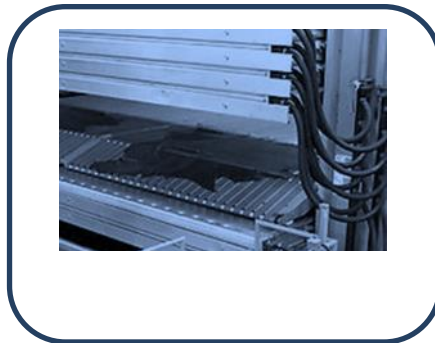
Figura 22.- Cuero siendo colocado en la máquina para secar al vacío
