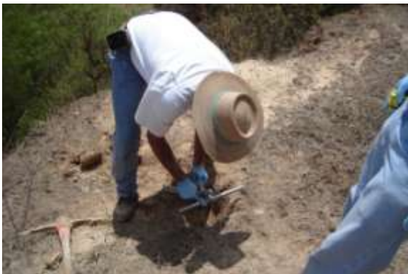
Figura IX-11 Extracción de muestra a 1 m de profundidad.
