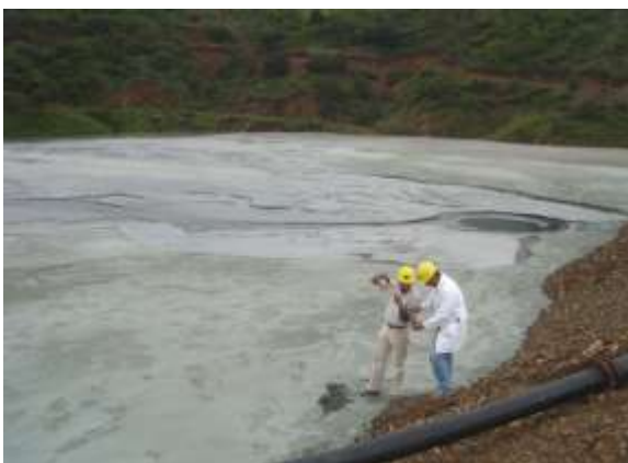
Figura VIII-18 Toma de muestra de la parte central del vaso de la presa.
