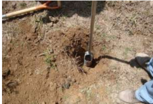
Figura IX-10 Perforación para toma de muestra a 1 m de profundidad.
