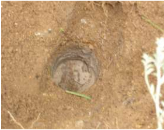
Figura VIII-16 Toma de muestra a 1 m de profundidad.
