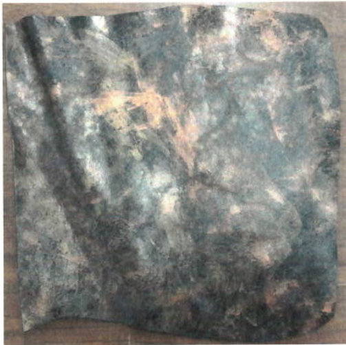
Figura 9. Carnaza de res color café chocolate muñequada con pigmentos de colores y cera. Planchada con espejo a 110°C
