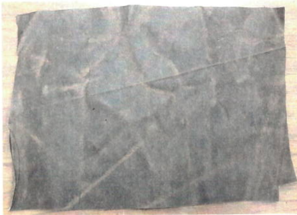
Figura 7. Carnaza de res color paja con acabado tipo crazy horse. Mezcla de productos lípidos y plancha con calor superior a los 100°C.
