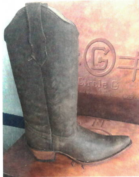
Figura 8. Prototipo de bota terminada. Tubo y chinela elaborados con carnaza de res descrita en la figura No. 7.
