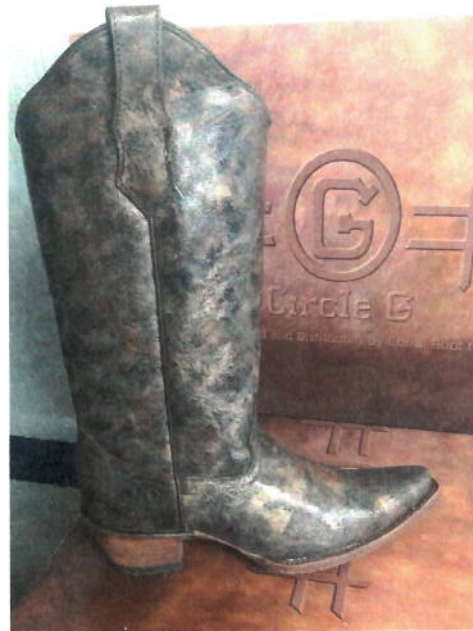
Figura 10. Prototipo de bota terminada. Tubo y chinela elaborados con carnaza de res descrita en la figura No. 9.
