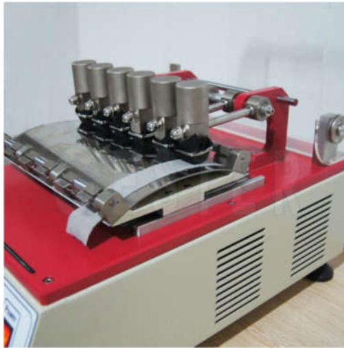
Prueba de Laboratorio: Resistencia al manchado tipo Gakushin
