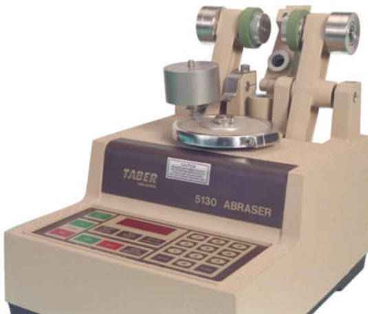
Prueba de Laboratorio: Resistencia al rasguño (scuffing resistance)
