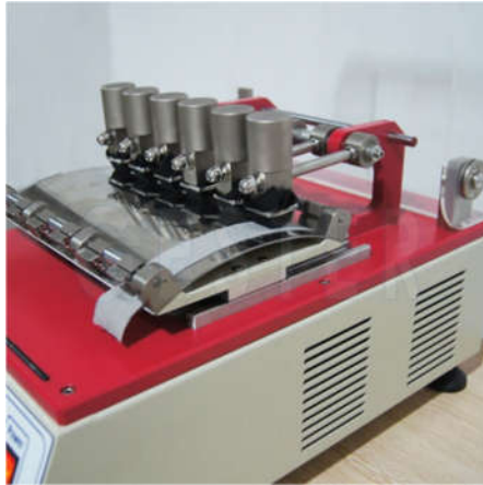
b) Equipo para resistencia a la abrasión tipo Gakushin
