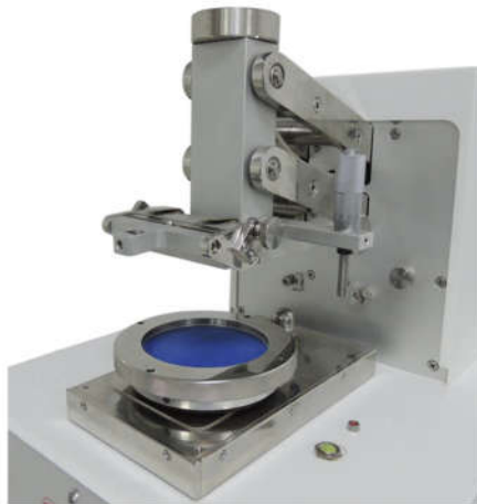
Prueba de Laboratorio: Resistencia al manchado tipo UWT (Universal Wear Testing). Se muestra equipo y muestra probada.
