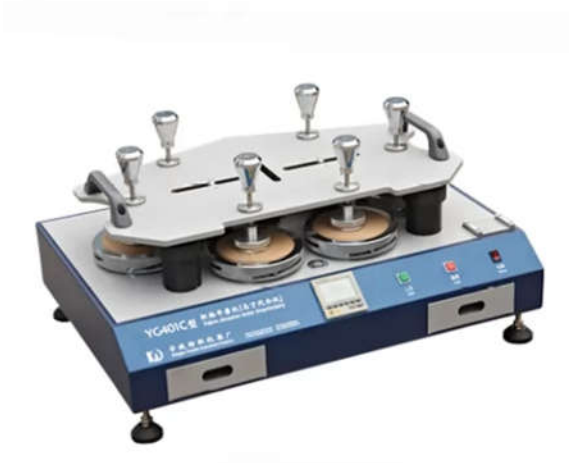
a) Equipo para resistencia a la abrasión tipo Martindale
