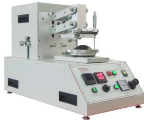
c) Equipo para resistencia a la abrasión tipo UWT (Universal Wear Tester)
