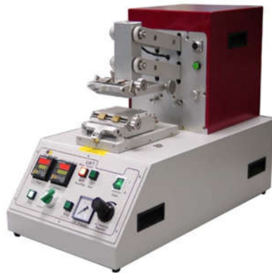
c) Equipo para resistencia a la abrasión tipo UWT (Universal Wear Tester)
