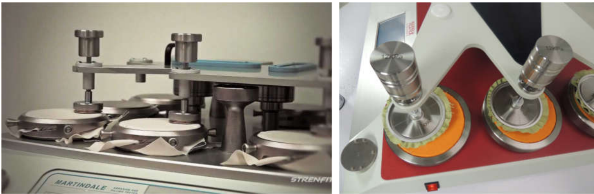
Prueba de Laboratorio: Resistencia al manchado tipo Martindale
