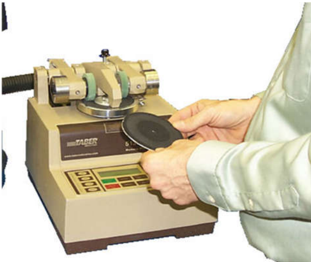
Prueba de Laboratorio: Resistencia al Desgaste tipo Taber (Taber abrasion resistance)
