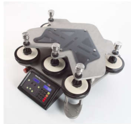
a) Equipo para resistencia a la abrasión tipo Martindale
