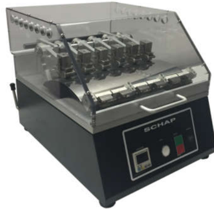
b) Equipo para resistencia a la abrasión tipo Gakushin
