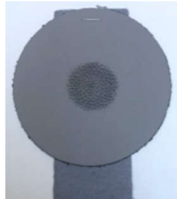
Prueba de Laboratorio: Resistencia al manchado tipo UWT (Universal Wear Testing). Se muestra equipo y muestra probada.
