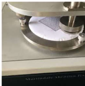
Patrón de Movimiento de equipo Martindale (Lissajouse)
