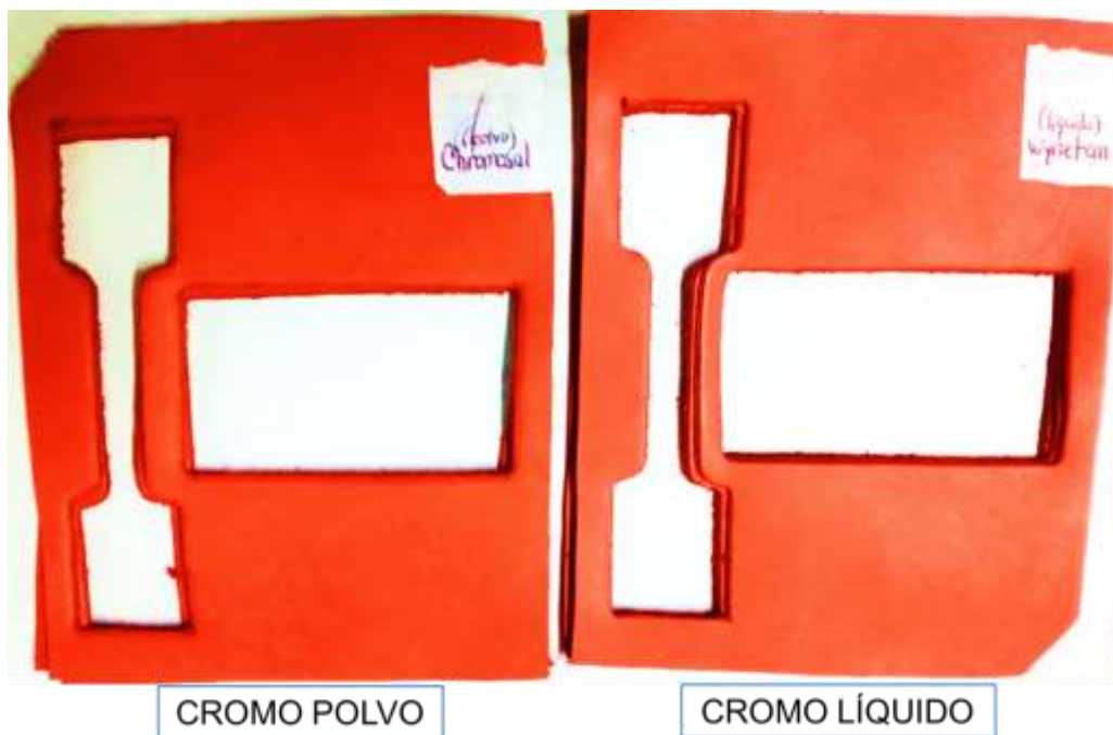
Figura 3.16. Comparación entre cuero curtido con cromo polvo (izquierda) y cuero curtido con cromo líquido (derecha).
