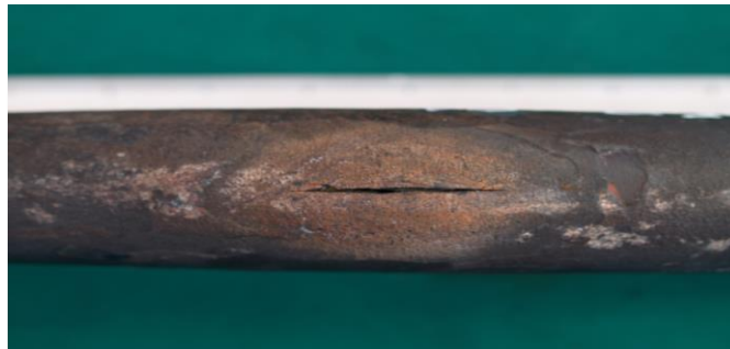
Figura 2.4 Falla por sobrecalentamiento prolongado.
