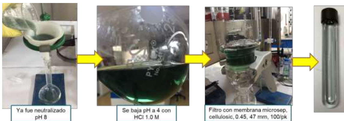
Imagen 2. Hidrólisis ácida con HCl 1.0 M de licor proteico seguida de un proceso de filtración en Millipore . En la membrana de 0.4 \mu\text{m} se quedan atrapados los compuestos y sales de cromo, por lo que una vez filtrado, el líquido se va volviendo transparente y cristalino.
