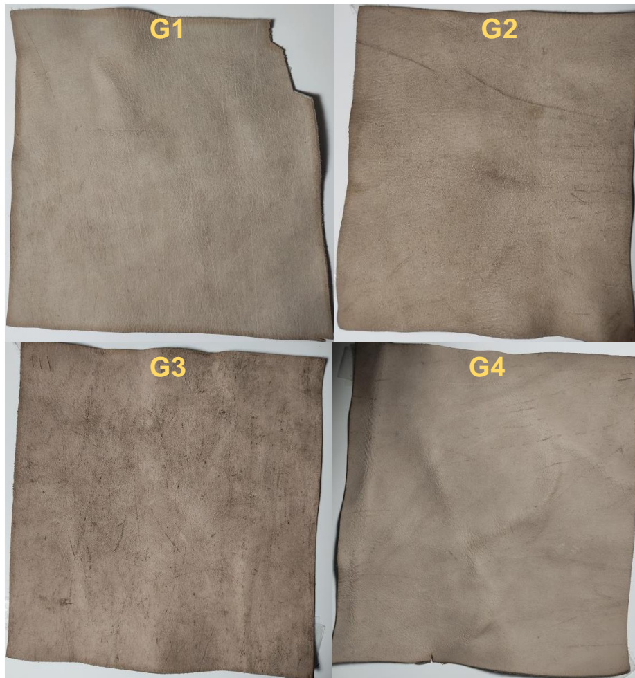
Figura 13. Imagen demostrando los resultados de la recurtición de probetas de cuero y que corresponden a G1, 0 % de OGr; G2, 0.5 % de OGr, G3, 1 % de OGr y G4, 2% de OGr.
