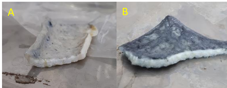
Figura 9. Imágenes de secciones de probetas de cuero curtidas con A) 0.05 % y B) 0.5 % de óxido de grafeno respectivamente.
