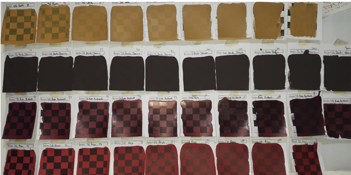
Imagen 37 Cobertura de pigmentos dependiendo la cantidad aplicada.
