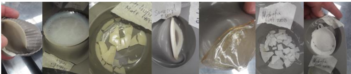
Imagen 42. Extracción de los Materiales de acabado de los moldes.
