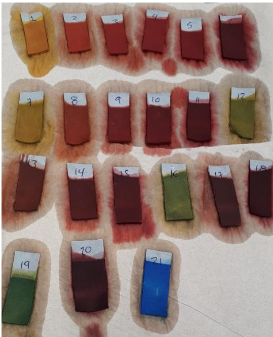
Imagen 48. Tiras de crust en solución al 5% de anilina secos
