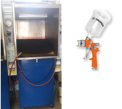
Imagen 1. Esquema del equipo necesario para la pulverización manual
