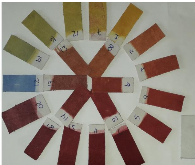
Imagen 50. Tiras de crust en solución al 3% de anilina
