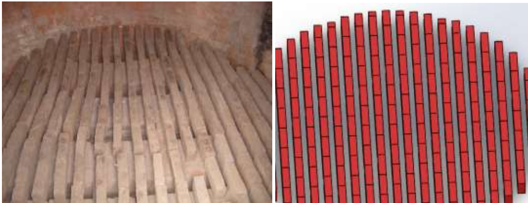
Figura A1. Acomodo de ladrillo de manera lineal perpendicular a la puerta de alimentación, real y virtual. Cama 1
