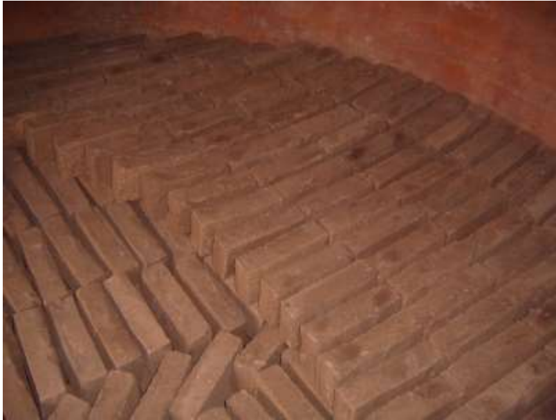
Figura A4. Acomodo de ladrillo de manera lineal. Cama 4, 5 y posteriores
