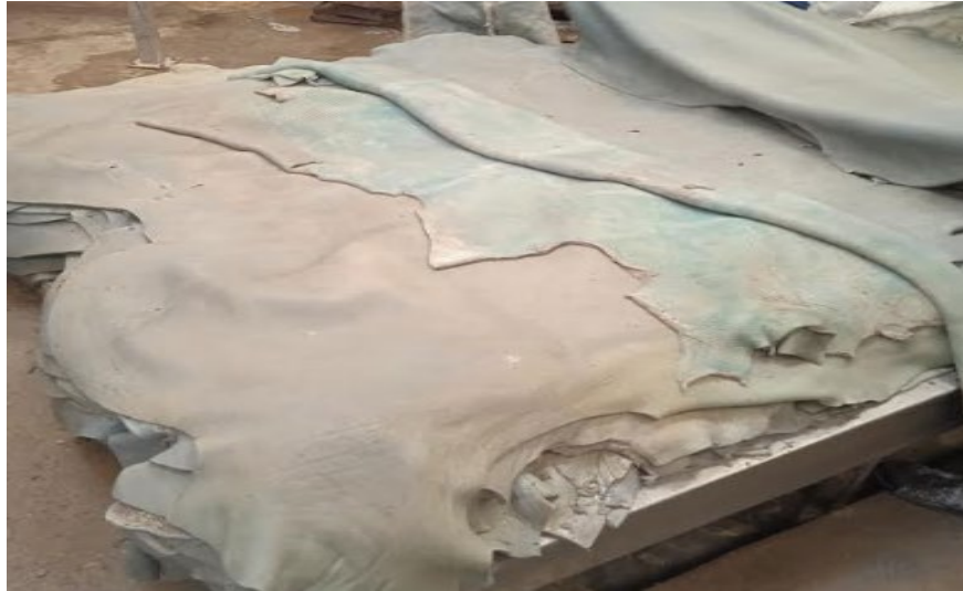
Foto #4 apariencia de la piel al concluir proceso de encalado
