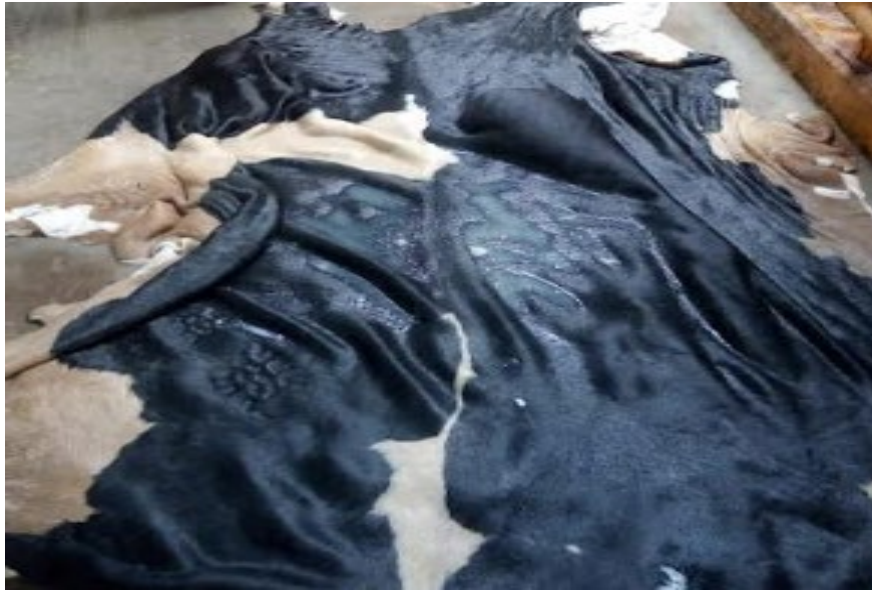
Foto#2 apariencia de la piel al finalizar el proceso remojo
