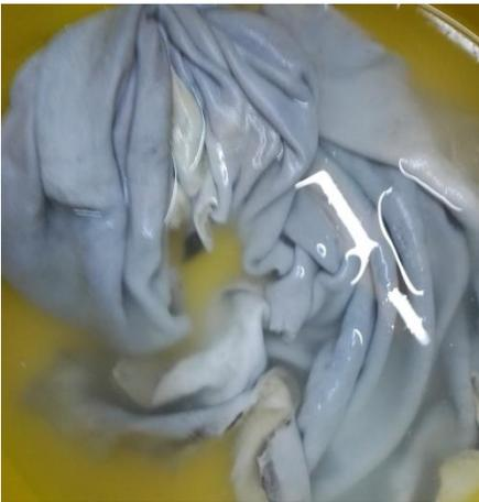
A continuación, se agrega el 0.4 % de ácido sulfúrico, diluido en 20 partes de agua, se agrega lentamente, distribuyéndolo. Se deja por 15 minutos hay que estar removiendo.
