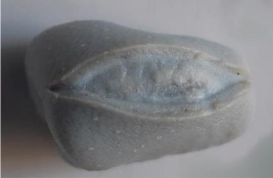
Una vez que se verifico que las sales de cromo basicidad 33 han atravesado la piel se procede a realizar la fijación. Esto se logra mediante el basificado. Aquí se tiene que hacer un cálculo para obtener el porcentaje requerido.
