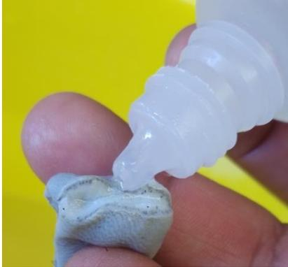
Figura 34. Aplicación de gotas de fenolftaleína para verificar un buen desescalado. Un color incoloro indica que hay un buen desescalado.
