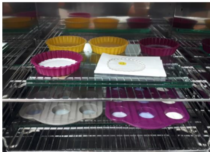
Ilustración 6. Resina en solución dentro del horno de secado
