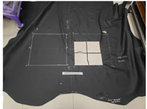
Figura 10: Corte de probetas mediante una suajadora de brazo hidráulico.
