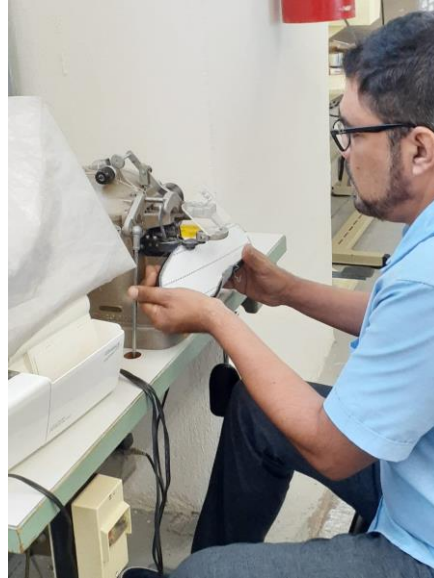
Figura: 18 Construcción Strobel. Foto tomada en el laboratorio de calzado CIATEC. Creación propia
