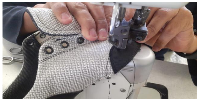
Figura: 26 Unión de piezas de Hemp. Foto tomada en laboratorio de calzado CIATEC. Creación propia
