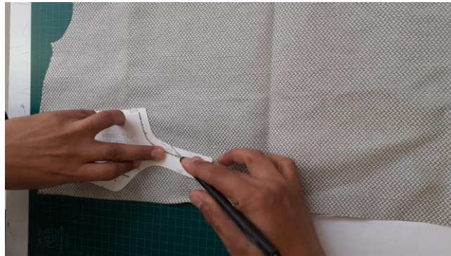
Figura: 25 Corte de piezas de Hemp. Foto tomada en laboratorio de calzado CIATEC. Creación propia
