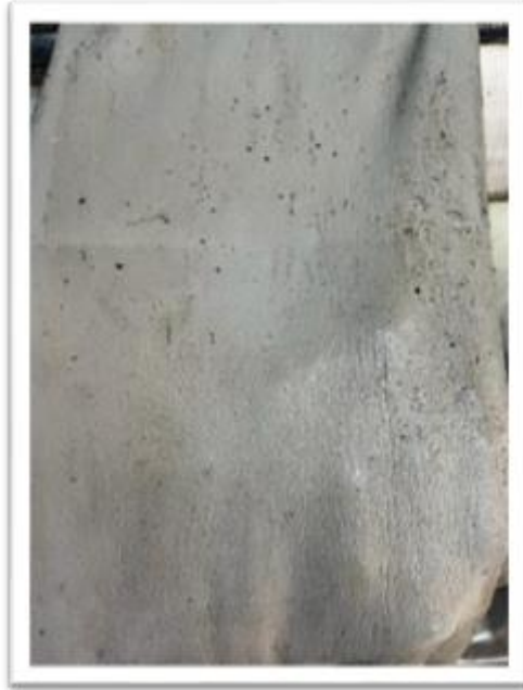
Figura 13. Observación de cuero recurtido con extracto de muérdago. En la figura se observa precipitación en la flor, ocasionado por baja solubilidad del extracto.
