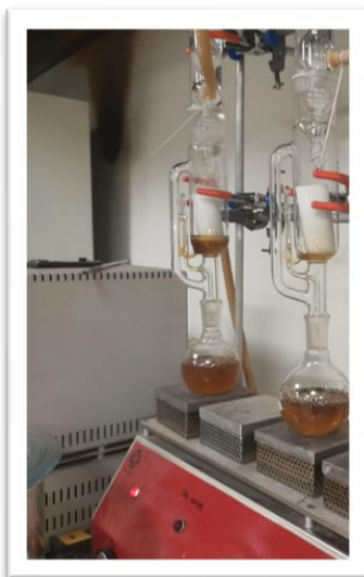
Figura 2. Extracción por método soxhlet. Izquierda: muestra 1; Derecha: muestra 2.
