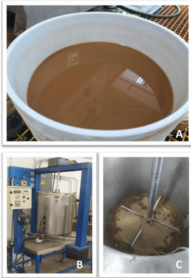
Figura 11. Equipo para extracción de pulverizado de muérdago. En la imagen A, se observa el extracto obtenido. En la imagen B y C el reactor utilizado para la extracción.
