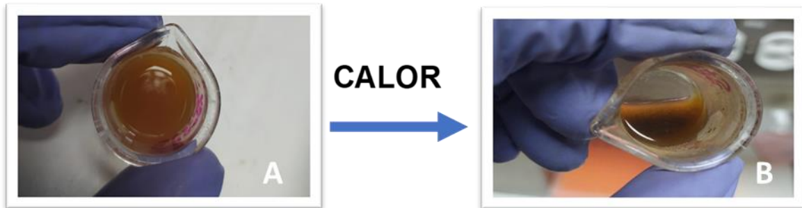
Figura 8. Prueba de presencia de taninos condensados mediante reactivo de Stiansy en muestra de extracto de muérdago. En la imagen A se muestra la mezcla del extracto con el reactivo de Stiansy previo a calentamiento. En imagen B, se muestra la mezcla del extracto con el reactivo de Stiansy posterior a adición de calor
