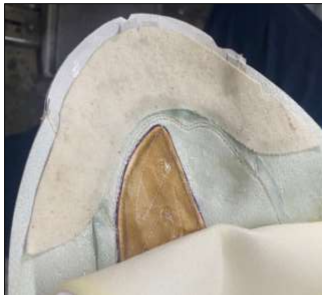
Figura: 37 Proceso de activado de casco y contrafuerte y aplicación de adhesivo. (Elaboración propia, 2023)
