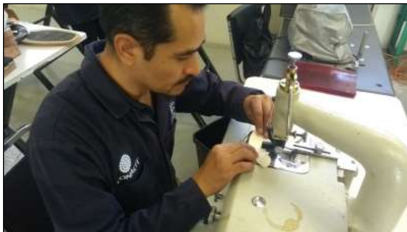
Figura: 35 Proceso de rebajado. (Elaboración propia, 2023)
