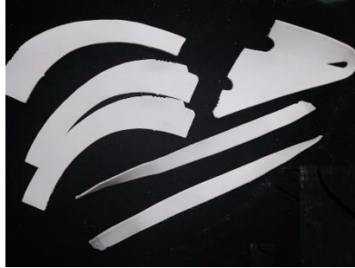
Ilustración 3. Piezas de 1-3398 Blanco procesado con desprendimiento de acabado.
