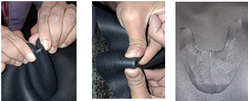
Ilustración 1. Chinelas y hojas de piel “producto 1-2445” donde se observa desgarre en las piezas.
