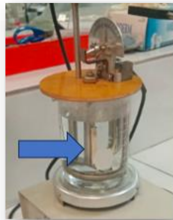
Imagen 14. Colocación de probeta en equipo para realizar temperatura de contracción, autoría propia (2023)
