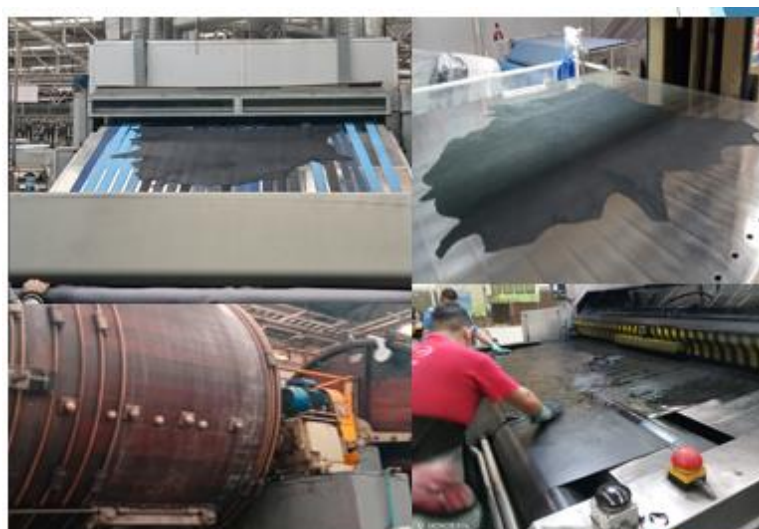
Imagen 19. Proceso de RTE y secado de cuero curtido con polímero orgánico, autoría propia (2023)
