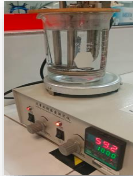
Imagen 15. Comienzo de prueba temperatura de contracción, autoría propia (2023)
