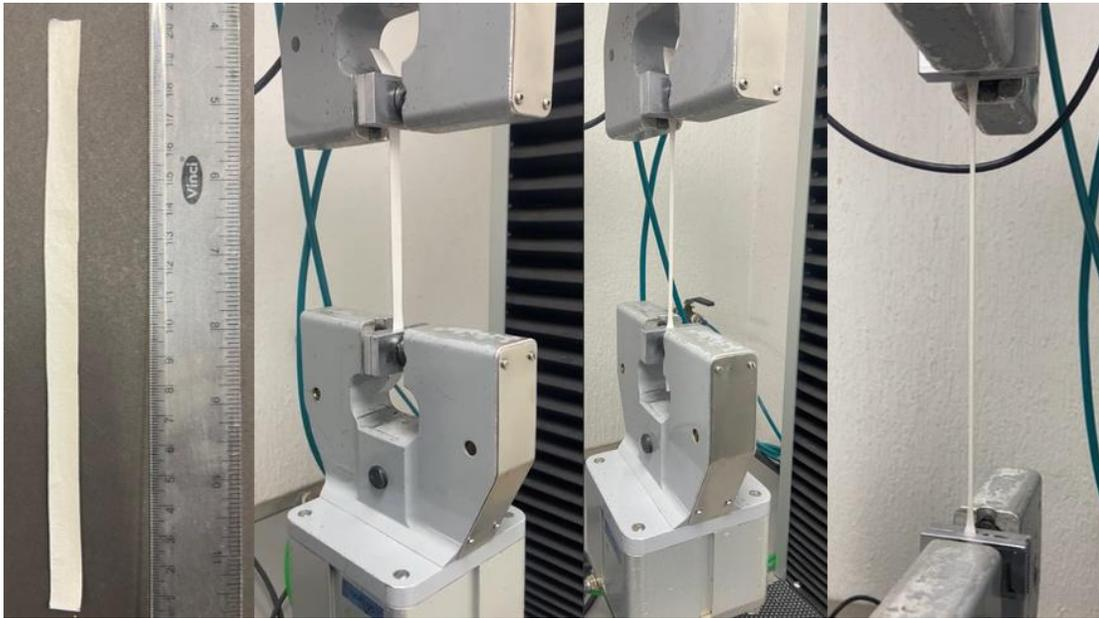
*Figura 24. Evaluación de las propiedades mecánicas de las fibras electrohiladas utilizando la máquina universal de ensayos.*
