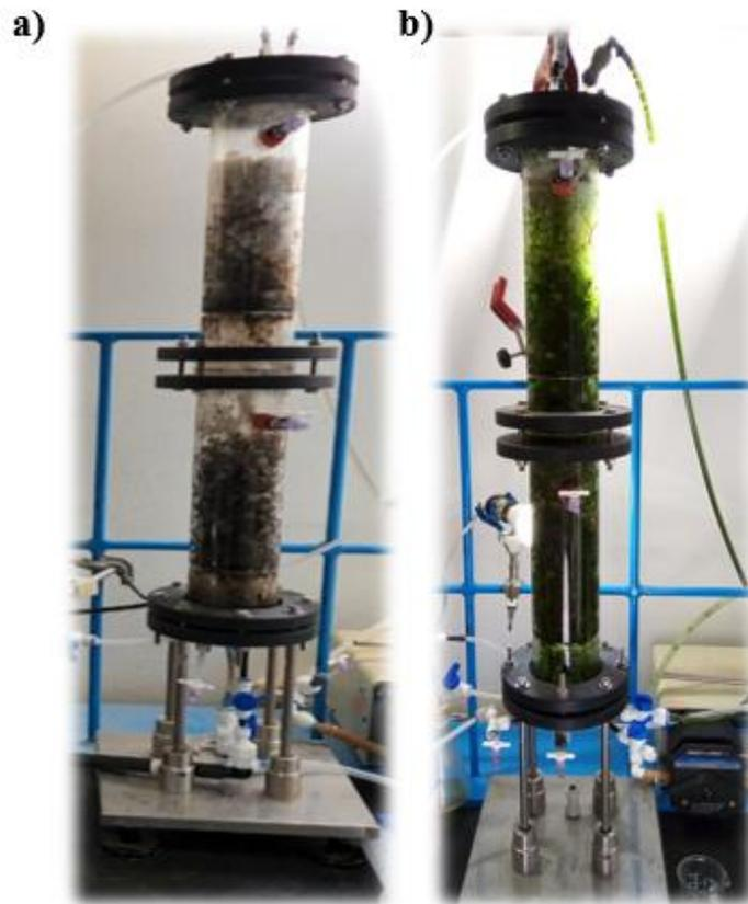
Figura A2.4. a) BTF en la etapa I de adaptación del consorcio; b) BTF en la fase III funcionando en estado pseudo-estacionario.
