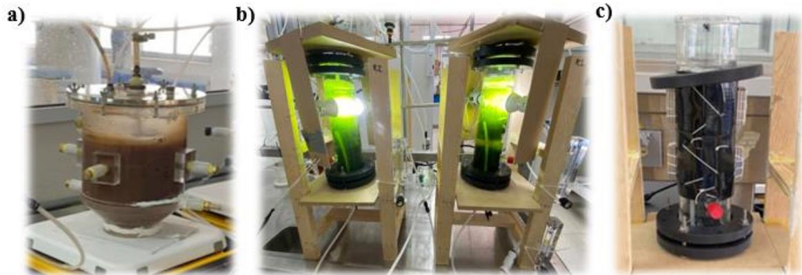
Figure A3.1. Montaje experimental del sistema acoplado a escala de laboratorio: a) S-CSTR; b) ARL expuesto y control; c) Montaje ARL expuesto a imanes de Nd como fuente SMF.
