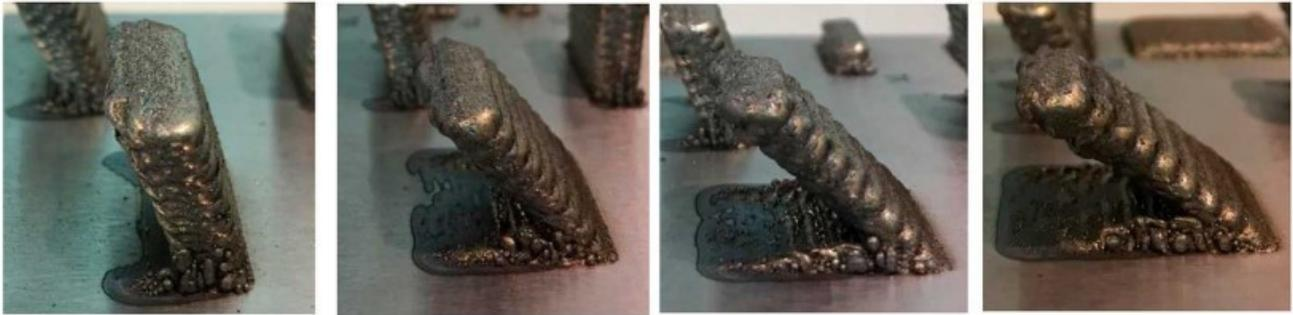
Figura 2. Paredes inclinadas a 70°,50°,45° y 40° con cuatro cordones por capa y el cabezal perpendicular al material basel.
