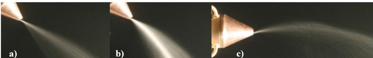
Figura 1. Geometría del cono de polvo con una inclinación de boquilla de  $45^\circ$  y, a) velocidad de polvo 78.19 g/min, b) velocidad de polvo 90.69 g/min y c) ángulo de  $90^\circ$  y velocidad de polvo 102.02 g/min.
