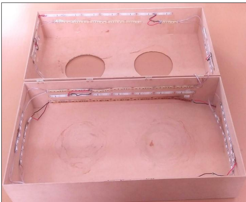
Figura 3. Caja adaptada para contener los biorreactores sometidos a luz LED.
