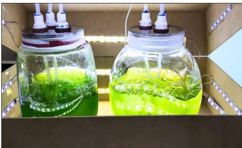
Figura 4. Biorreactores en operación sometidos a iluminación LED. A la izquierda, cultivo de N. oleoabundans , y a la derecha, C. vulgaris .
