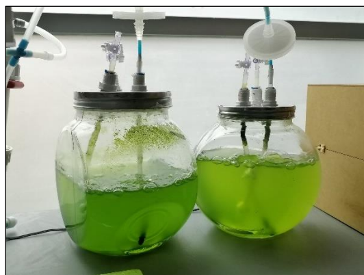
Figura 2. Biorreactores en operación sometidos a luz solar. A la izquierda, cultivo de N. oleoabundans , y a la derecha, C. vulgaris .
