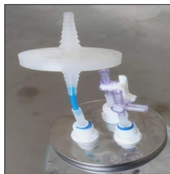
Figura 1. Adaptación de las tapas de aluminio para los biorreactores donde a) horadación de la tapa de aluminio, b) filtro de membrana en la entrada de aire.
