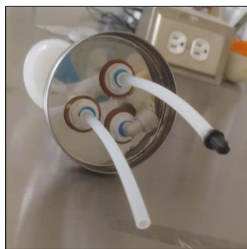
Figura 1. Adaptación de las tapas de aluminio para los biorreactores donde a) horadación de la tapa de aluminio, b) filtro de membrana en la entrada de aire.
