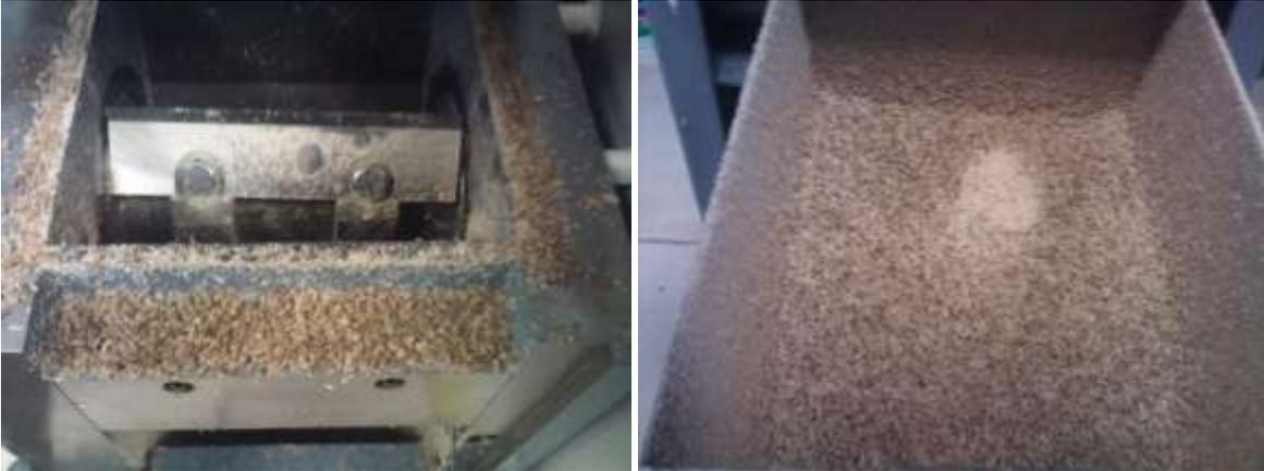
Figura 28 Molino de cuchillas giratorias para procesar los trozos extruidos de composite (izq.); material molido y cribado (der.)
