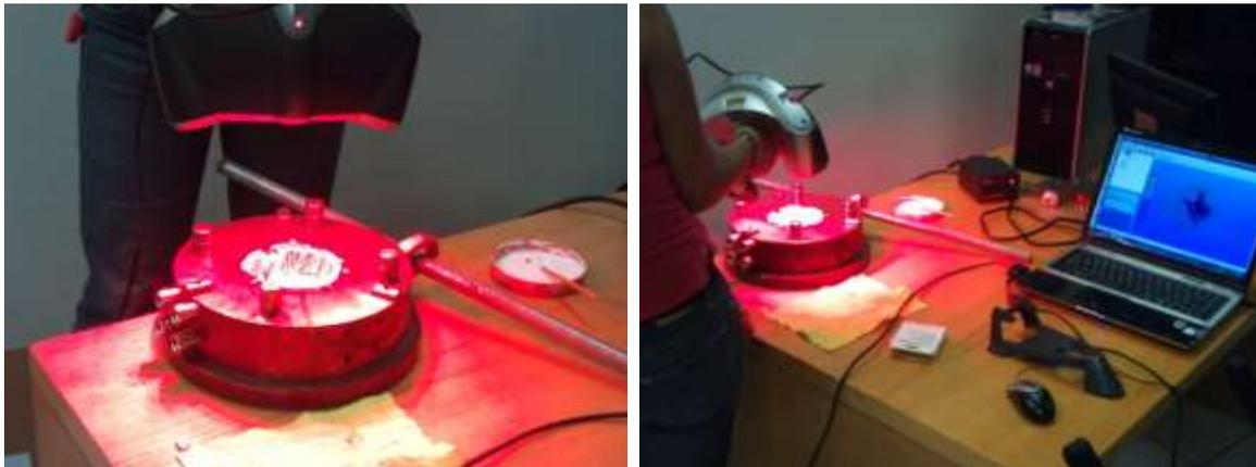
**Figura 14** Escaneo láser del molde de inyección.
