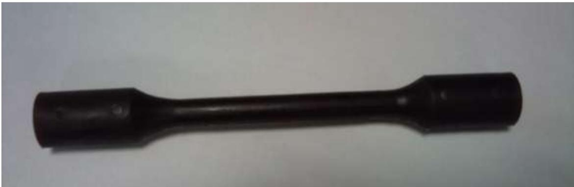
**Figura 33** Pieza de polipropileno con fibras sometida al estudio de su contracción
