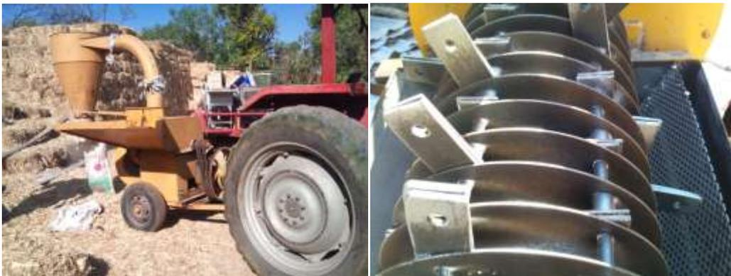
**Figura 4 Molino de martillos conectado al tractor y su mecanismo interno**
