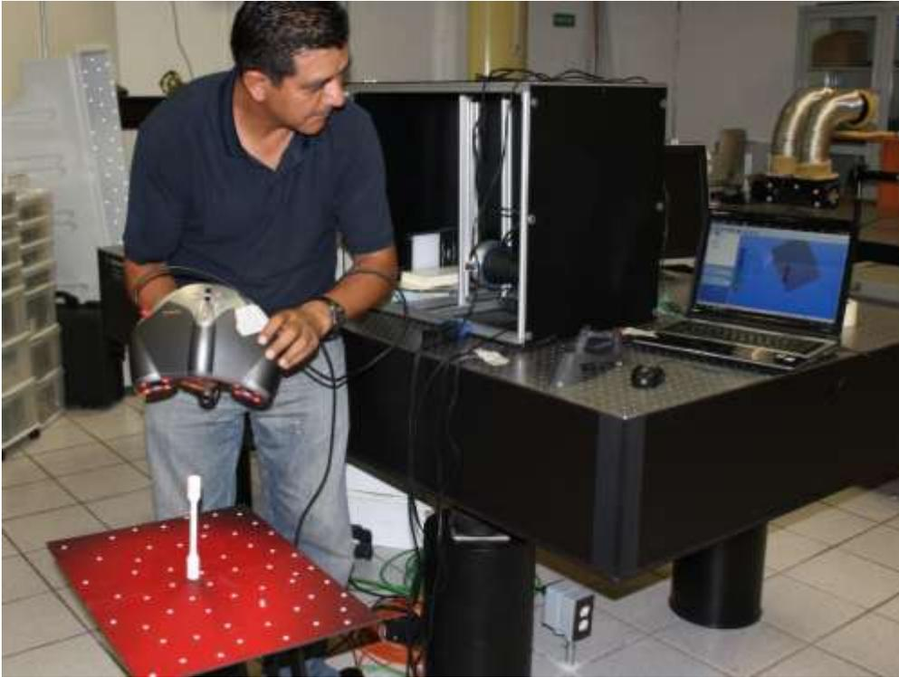
**Figura 36** Proceso de escaneo laser de la pieza colocada sobre una superficie patrón con puntos de referencia.
