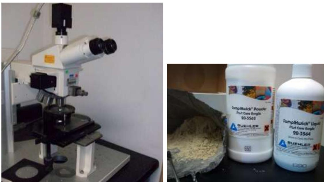
**Figura 20** Microscopio óptico (izq.) y resinas acrílicas usadas en la generación muestras para microscopía (der.)
