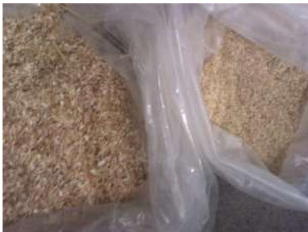
Figura 3 Fibras molidas, a la izquierda con el molino Pagani, a la derecha con ambos molinos.
