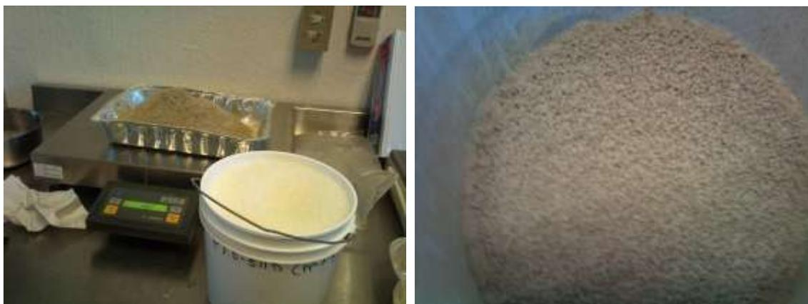
Figura 26 Pesaje de componentes para el composite (izq.) y componentes mezclados físicamente (der.)
