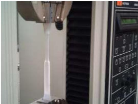
**Figura 10** Probeta de polipropileno en el ensayo de tensión
