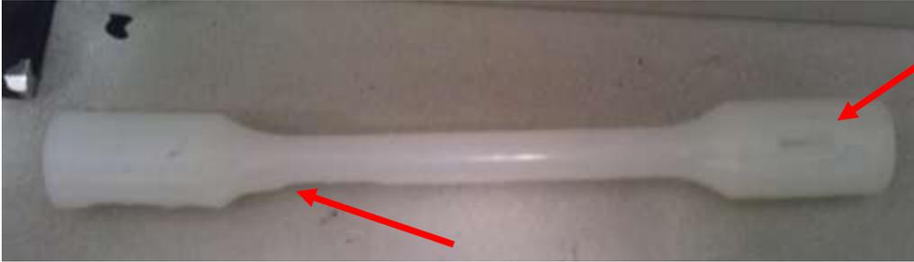
**Figura 9** Pieza inyectada que presenta problemas de hundimientos.
