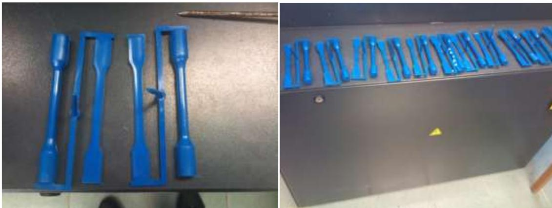
**Figura 8** Piezas de polietileno inyectadas en pruebas preliminares.
