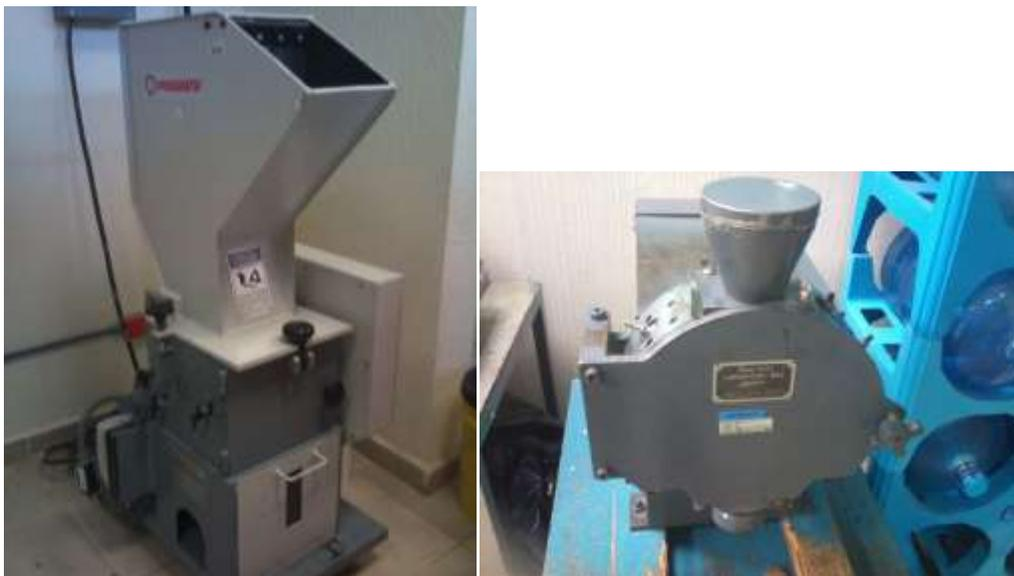
Figura 2 Molinos de cuchillas industrial (izquierda) y de laboratorio (derecha).
