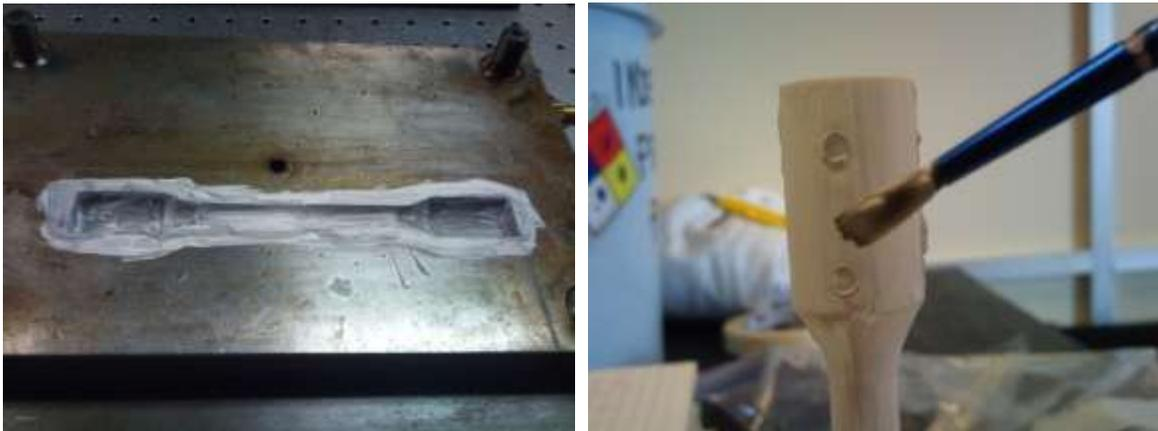
**Figura 35** Aplicación de sulfato de bario en las piezas que serán escaneadas
