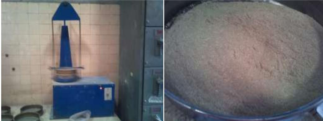
Figura 6 Vibrador con tamiz y fibras después de ser molidas y tamizadas
