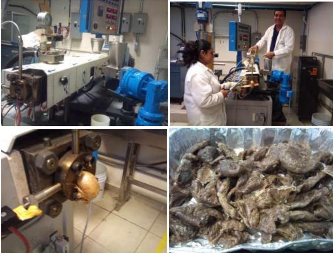
**Figura 27** Equipo de extrusión y proceso de desarrollo del composite
