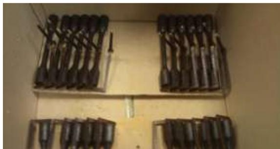
Figura 31 Codificación de probetas durante las corridas experimentales. Sin fibras (izq.) y con fibras (der.)
