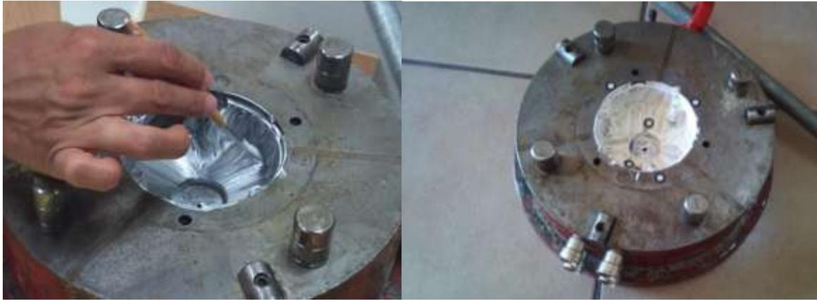
**Figura 13** Preparación de la superficie de las piezas con solución de sulfato de bario.
