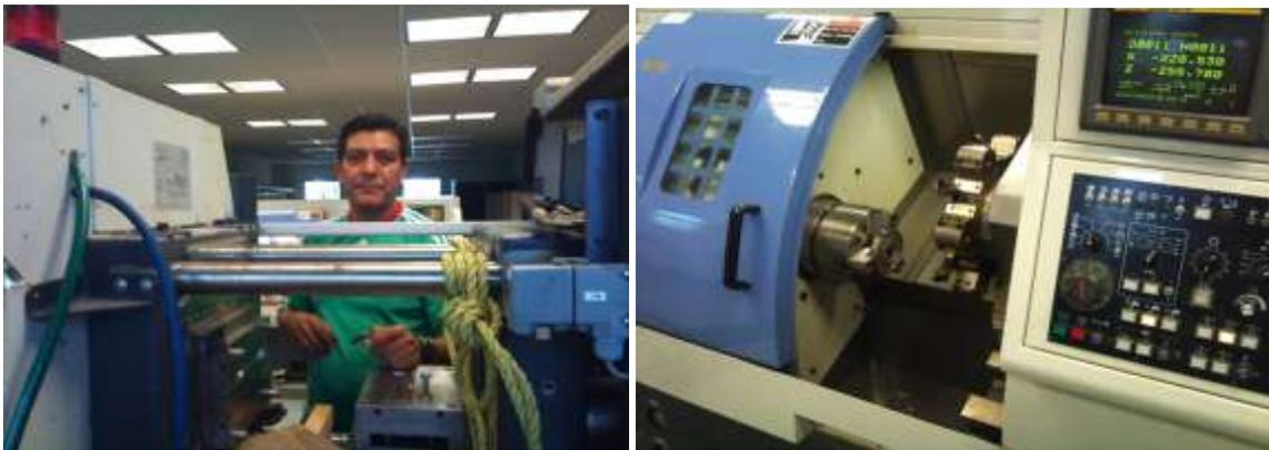
**Figura 7** Montaje del molde en la inyectora (izq.) y torno CNC con la pieza para adaptación (der.)
