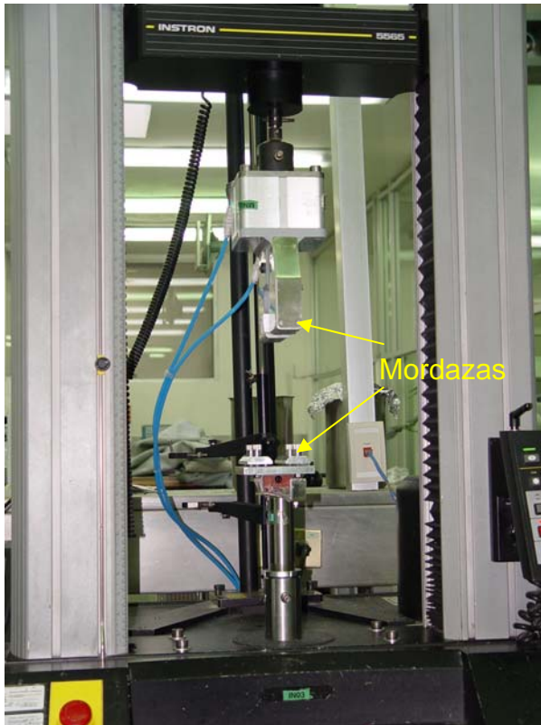
Figura 3.8.- Equipo para la prueba de adherencia.
