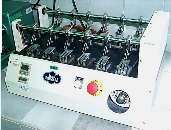
Figura 3.6.- Equipo para la prueba de flexión.
