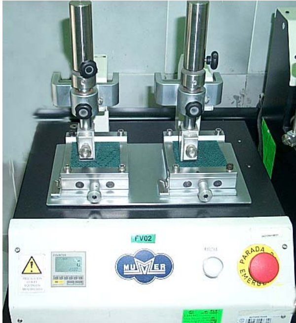
Figura 3.7.- Equipo para la prueba de fricción.
