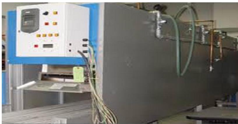
Figura 3. 1: Equipo de secado infrarrojo prototipo
