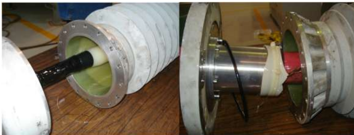
Fig. 3.10 Falla en terminales
